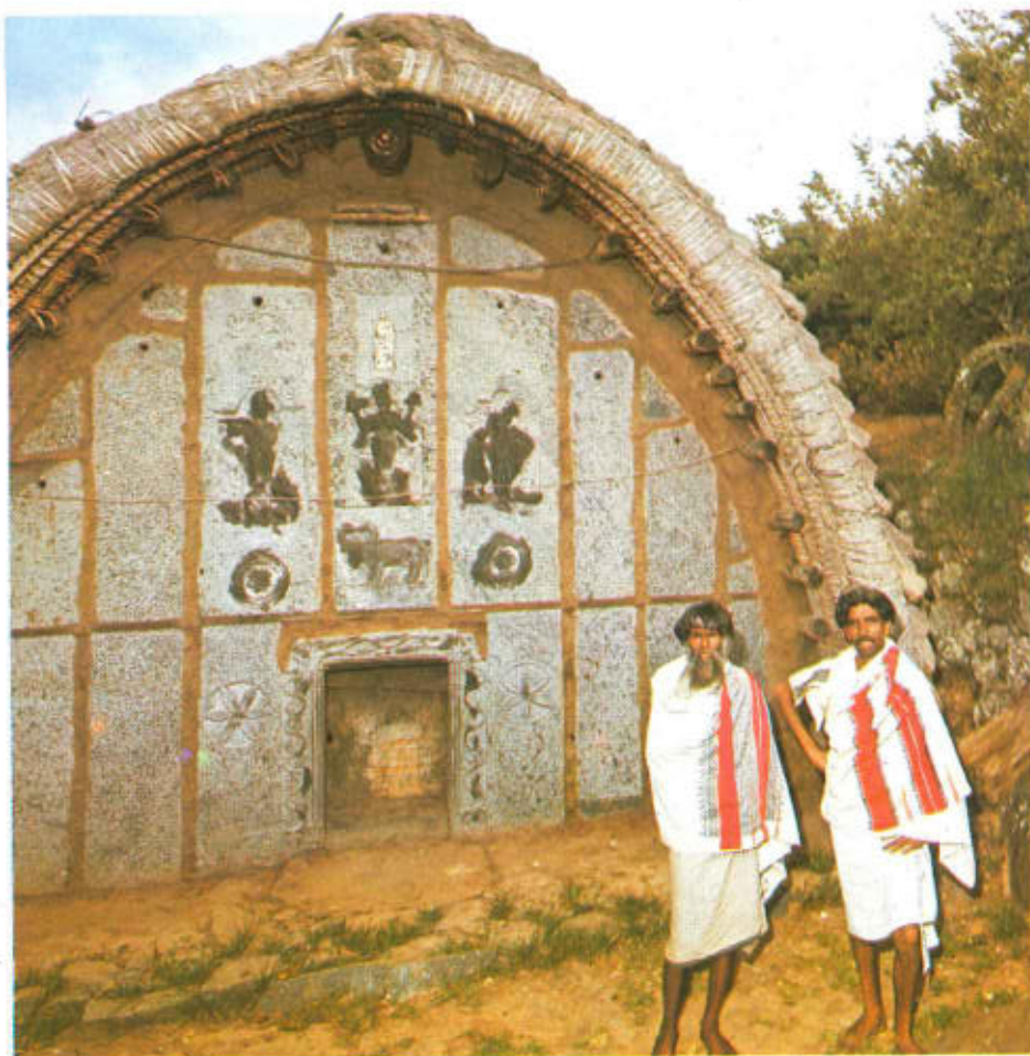
Dos toda delante de la puerta de una de sus casas. Los toda son un pueblo de pastores de búfalos que viven en la meseta del Nilgiri, en el sur de la India. Destacan, entre otros aspectos, por la originalidad de su arquitectura. Así, por ejemplo, construyen casas a base de bálago (paja trillada) y bambú, en las que las paredes laterales son una amplia continuación del techo.
